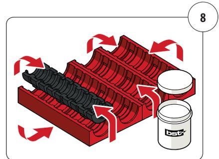
Kabeldurchmesser erfassen, Module bestimmen, adaptieren, einfetten ...
